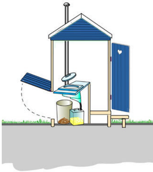
Figur 12. Skiss över urinsorterande insats i utedass, med uppsamling av urin och fekalier under sittbänken. (Illustration: Johan Palmcrantz.)
