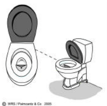
Figur 2. Det finns olika typer av urinsorterande toaletter, från de enklaste torrtoaletterna till mer moderna toaletter i porslin. En urinsorterande vattentoalett har två utlopp. Bakre delen, där fekalier och papper hamnar, spolras som en vanlig vattentoalett. Främre delen spolras oftast också, fast med liten mängd vatten. (Illustration: Johan Palmcrantz).
