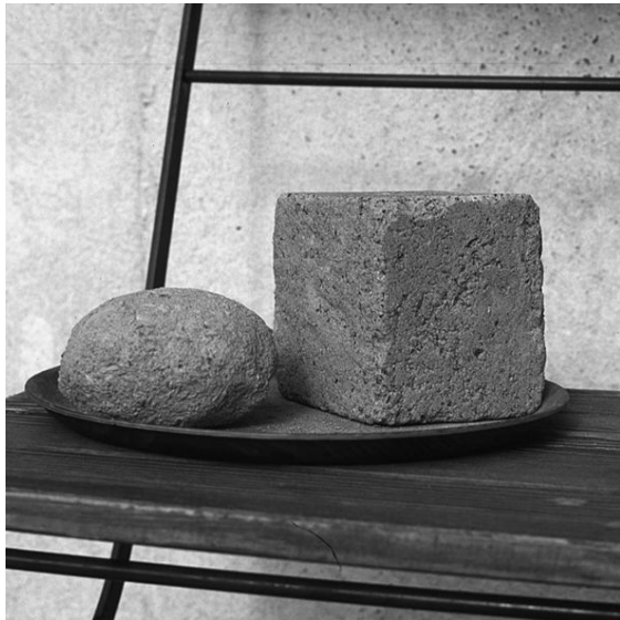
Fig 4.3. Prover av stampjordvägg och isolerlera.
