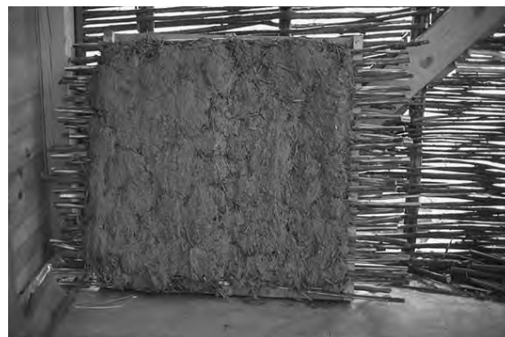
Fig 4.37. Lerklinad testyta som fått torka.
