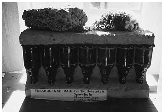
Fig 5.16. Modell av grundläggningens kapillärbrytande skikt.
