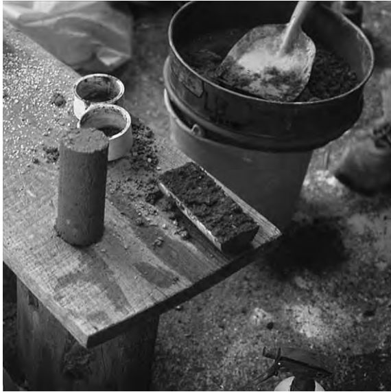
Fig 9. Detta test visar en olämplig kornstorleksfördelning i jordmassan. Här har de grövsta fraktionerna sållats bort. Detta resulterar i att provet inte är tillräckligt starkt för att hålla samman när det ska lossas från cylindern och därför ligger den kvar i cylinderhalvan. Den stående lerjordscylindern har en korrekt sammansättning.
