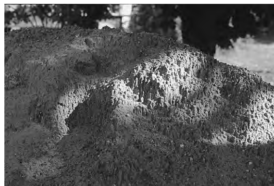
Fig 4. Sand, fungerar både som armering och ballast.
