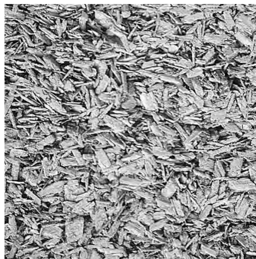
Fig 44. Träflis som binds samman av lera krymper obetydligt när massan torkar.
