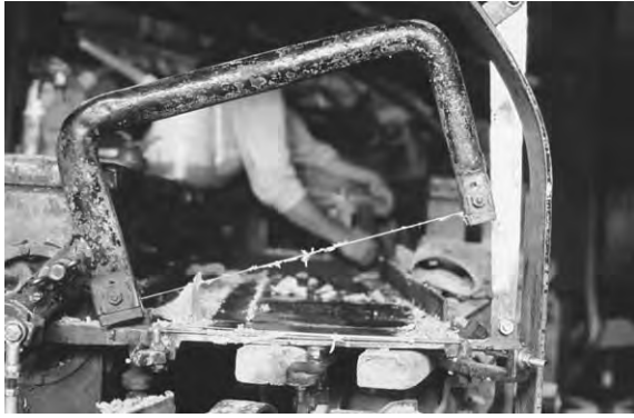
Fig 31. Lersträngen kapas till önskad höjd med pianotråd.
