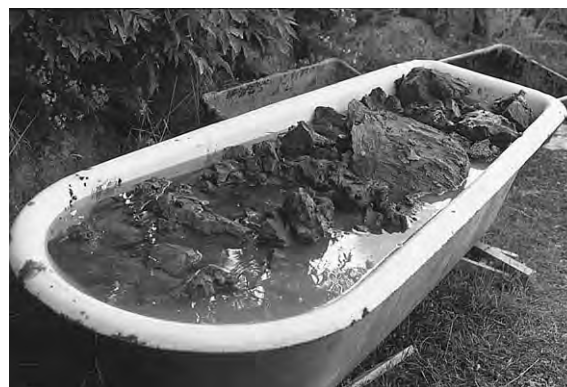
Fig 46. Lera bör sumpas, läggas i vatten, oavsett vad den används till, så att lermassan mätas med vatten.
