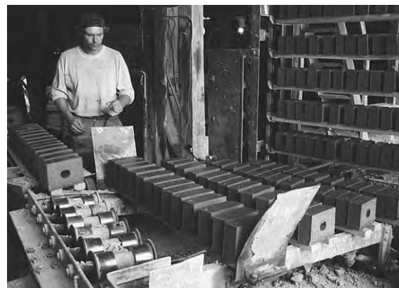
Fig 30. Tillverkning av råtegel vid Bältarbo tegelbruk. Stenarna på bilden är så kallade 20-stenar som fram till 1970-talets senare del förekom vid murning av mellanväggar. Eftersom brukets mekaniseringsgrad inte är heltäckande kan korta serier framställas och lerstenar levereras till ett något lägre pris än tegel.
