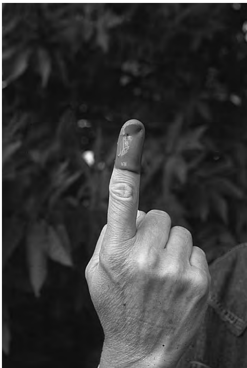
Fig 48. Fingertest. Rätt konsistens på lervällingen för blandning till isolerlera.
