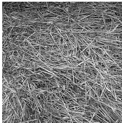
Fig 3. Halm - en av de vanligaste armeringarna i lerjordsmaterial.
