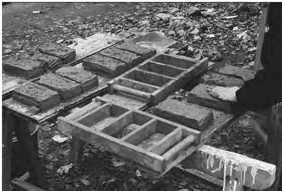
Fig 29. Här demonstreras rationell handslagning av lersten där stenen slås i en form som placerats på en skiva. Ett lager sand mellan skiva och lersten fungerar som smörjmedel som gör att stenen inte fastnar på underlaget när den torkar. När stenen är halvtorr vänds den och ställs på löpsidan så att torkningen kan ske effektivare.
