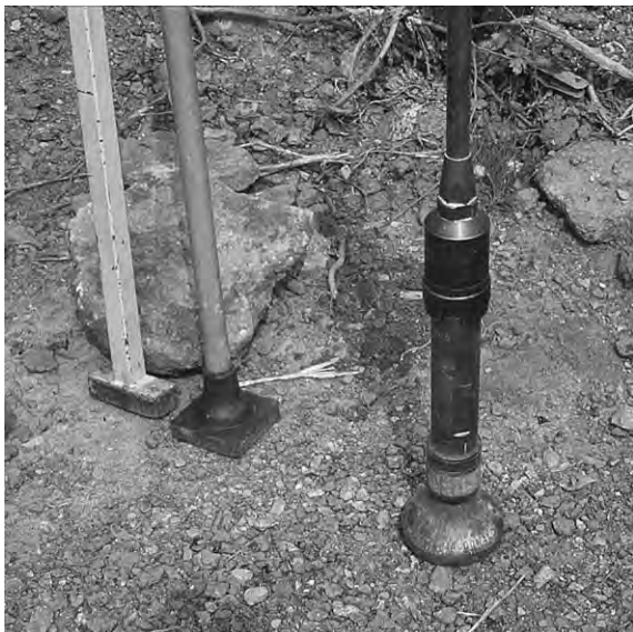
Fig 13, 14. Stampverktyg av trä respektive metall. Den övre bilden visar metallskodda trästampar och del av en form som användes till husen i Steninge, i Halland, 1944. På den nedre bilden visas två manuella metallstampar och en maskinstamp.
