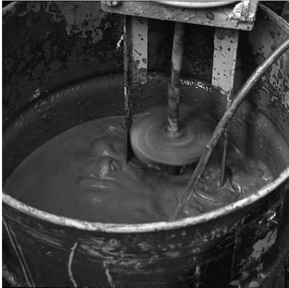
Fig 47. Vid tillredning av lervälling tillsätts vatten i förhållande till hur tung man vill ha den färdiga väggen. Ju effektivare maskiner desto kortare tid behöver leran sumpas.
