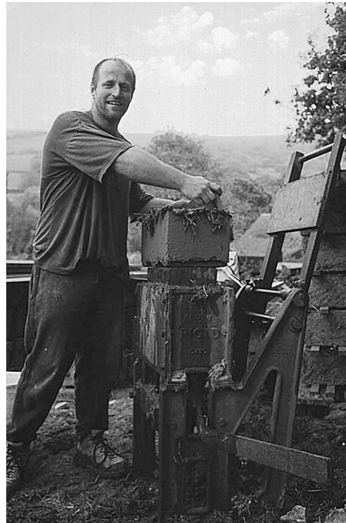
Fig 14. Kevin McCabe demonstrerar hur han tillverkar ler-block som han sedan använder till renoveringsarbeten. I den manuella blockpressen kan han framställa 100 block per dag. Varje block väger cirka 25 kg.
