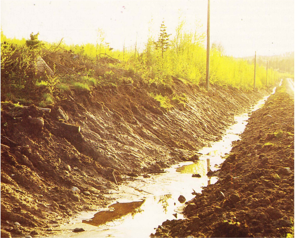
Ytligt grundvatten vid vårflod i Kassjöområdet, Medelpad. I vägskärningen vid foten av en lång moränsluttning blänker det utströmmande grundvattnet i motljuset. Vattnet i den omättade zonen kan inte spegla solljuset; vattenskikten kring mineralkornen är alltför tunna och de små vattenytorna i porerna är krökta inåt. Foto: Göran Nyberg.
